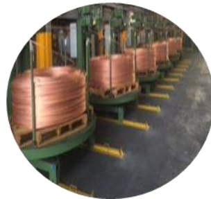
COLADAS VERTICALES (Oxigen Free Y ALEACIONES)
